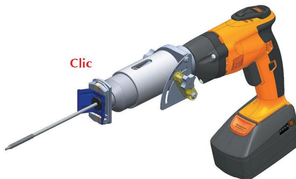
2/ Aligner le cavalier sur la nervure de la toiture et commencer le vissage. (Inclinomètre pour poser droit).
